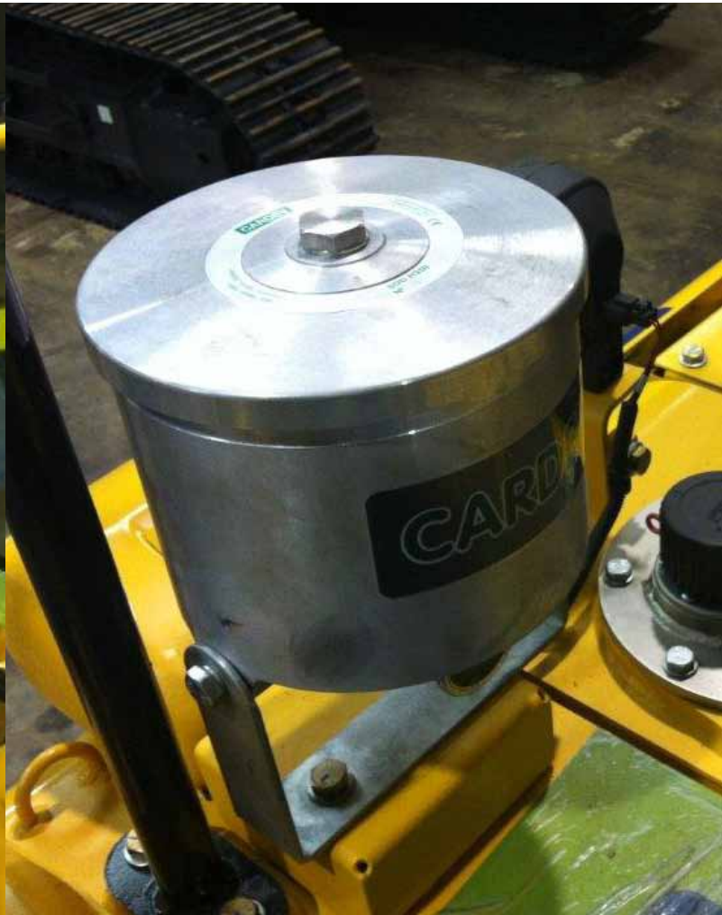
SDU H8 monte edilmiş KOMATSU ekskavatör
